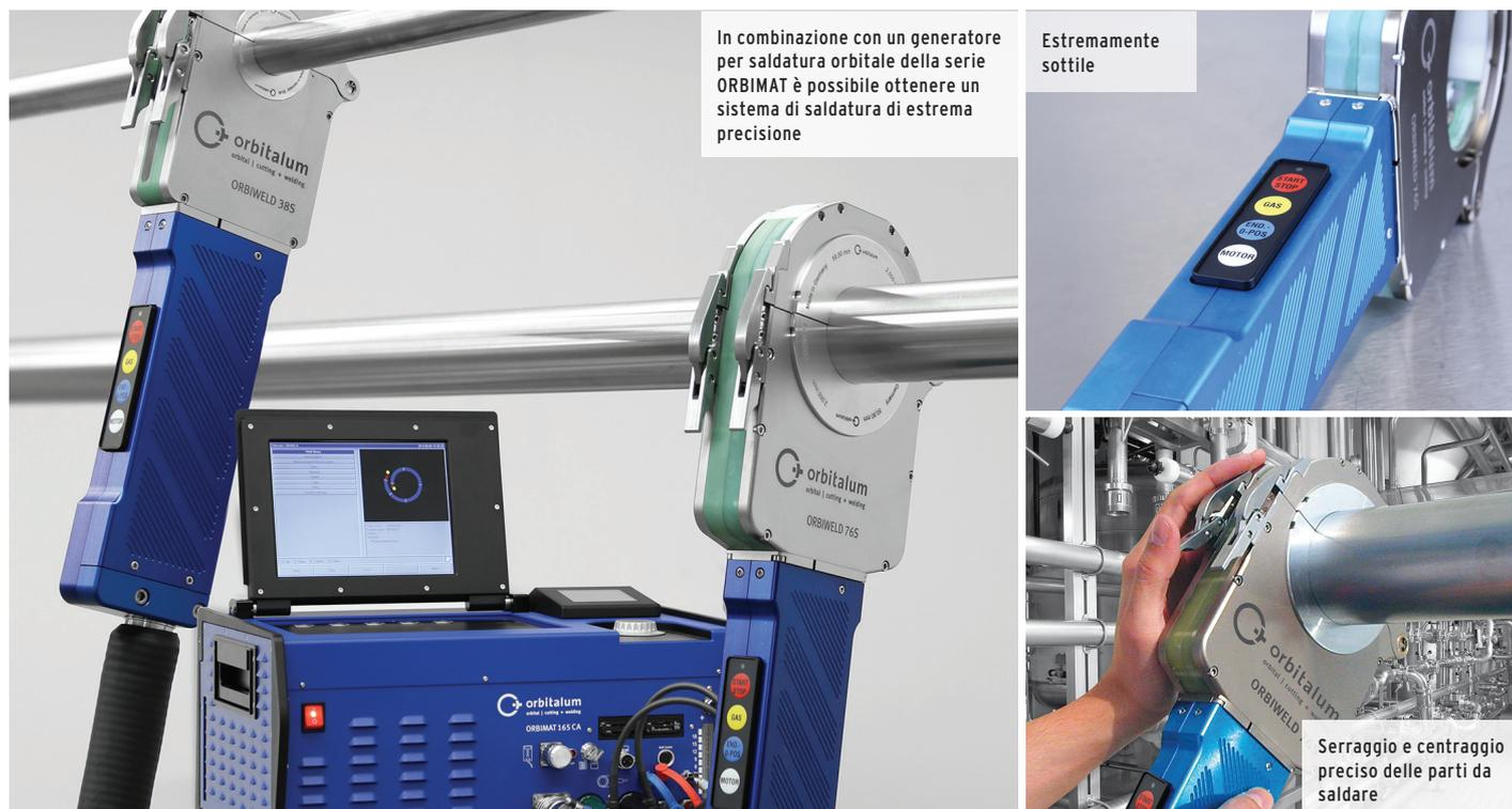
In combinazione con un generatore per saldatura orbitale della serie ORBIMAT è possibile ottenere un sistema di saldatura di estrema precisione
