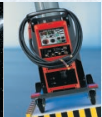
Tilt test to EN 60974-1
