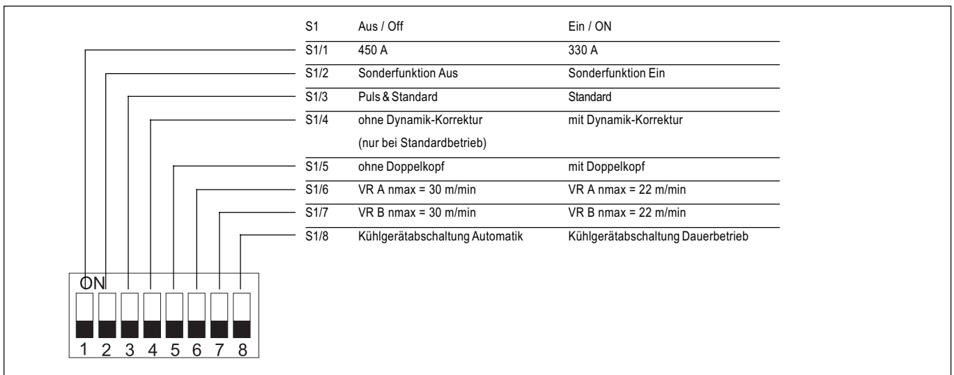
Abb. 26 Codiermöglichkeiten am Print NMI4.
